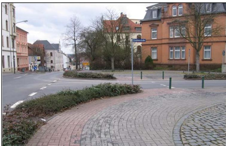
Bild 3-8 Verschwenkte Führung einer Geh-/Radweganlage (Von-Schildeck-Straße / Brauhausstraße)
