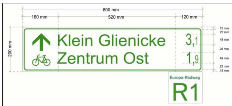
Bild 4-21 Beispiel eines Zielwegweisers mit eingehängter Routenplakette (Potsdam)
