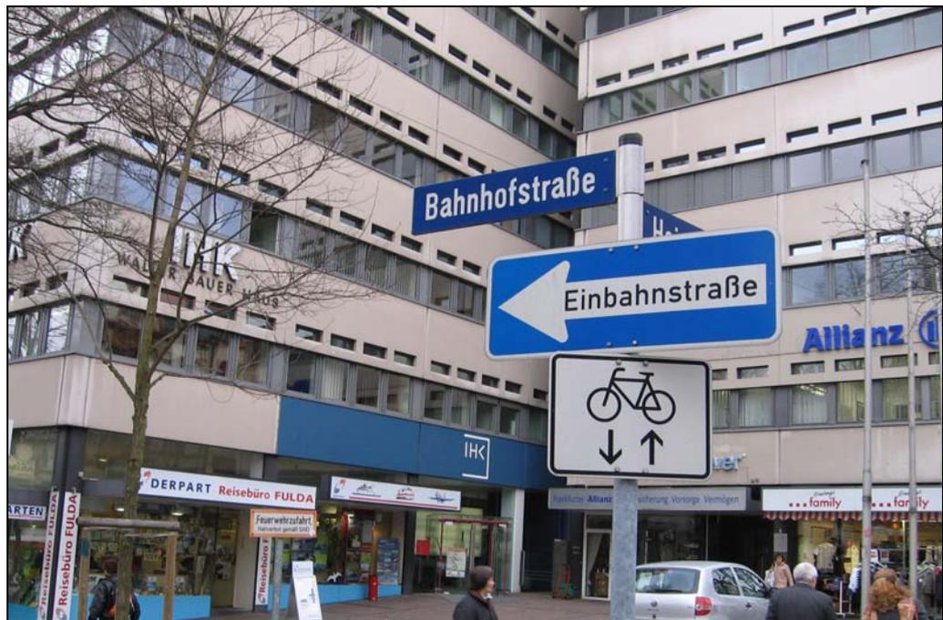
Bild A-3: Freigabe von Einbahnstraße für den Radverkehr in beiden Richtungen (Bahnhofstraße)
