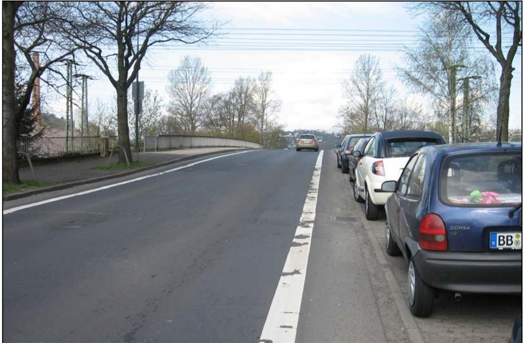
Bild A-25: Breite des Radfahrstreifens unter Mindestanforderungen sowie zusätzliche Gefahr durch parkenden Fahrzeuge (öffnende Türen) (Mackenrodtstraße)
