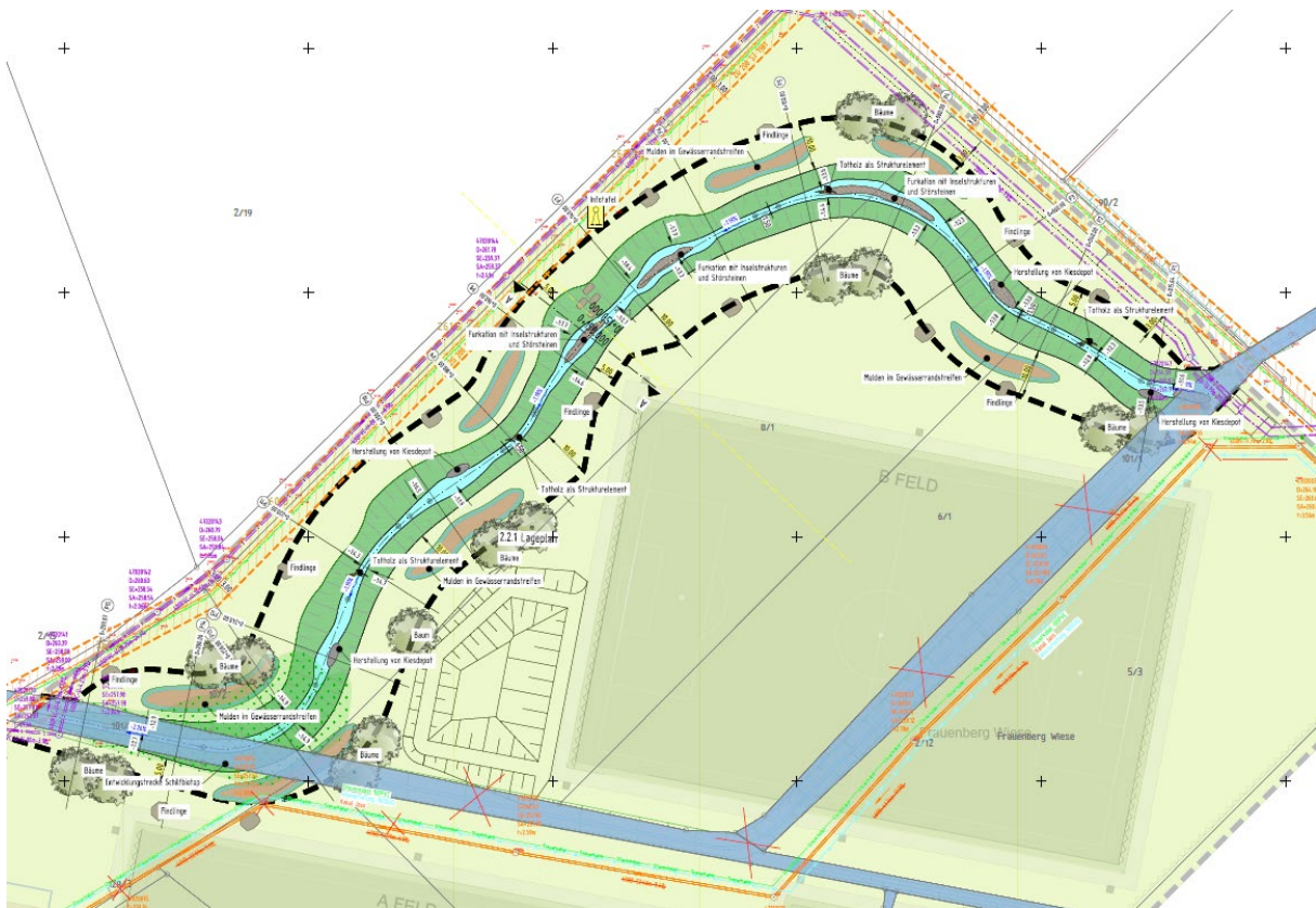
Abbildung 20: Übersicht Umverlegung "Lehnerzgraben"
