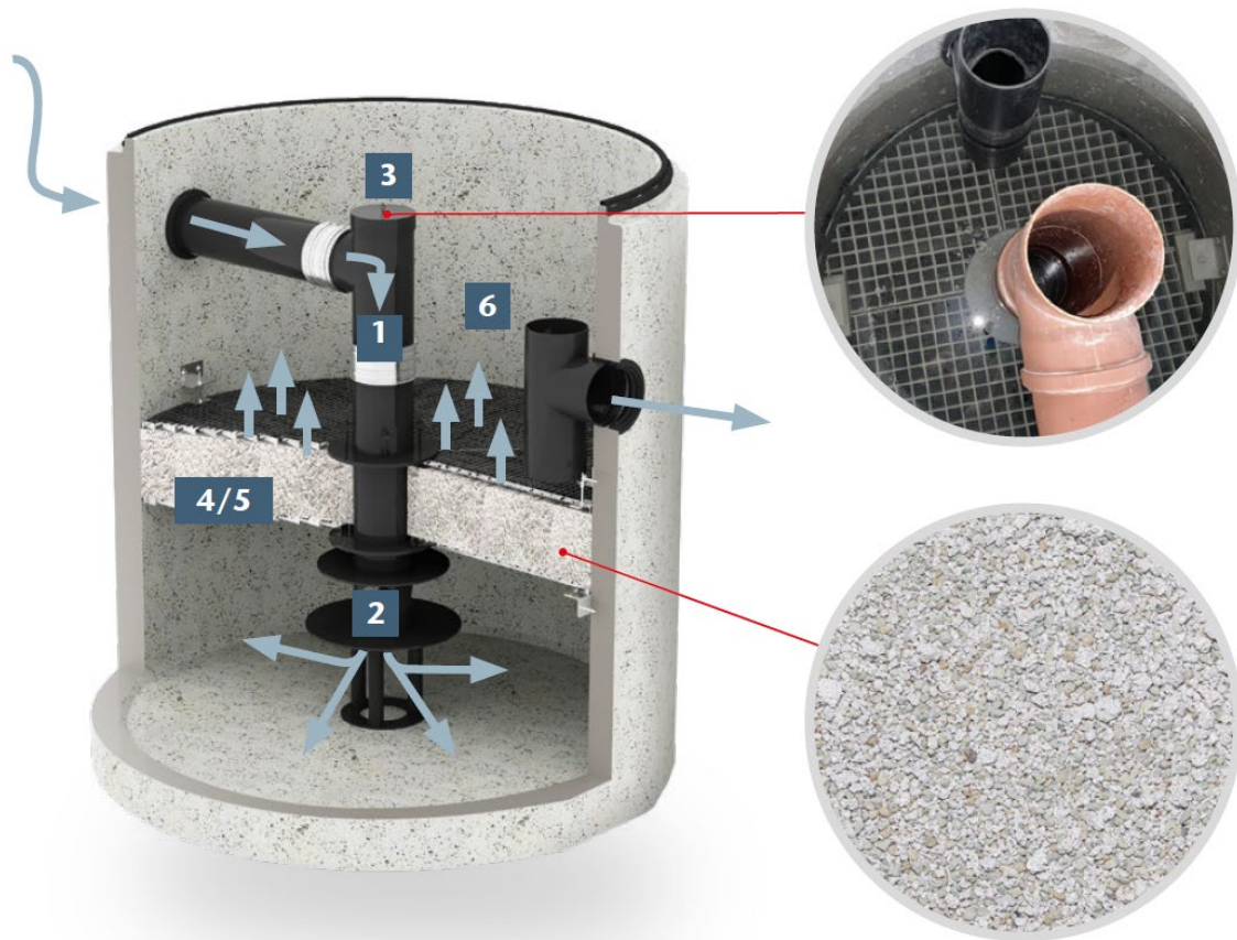
Abbildung 33: Beispielzeichnung ACO Sport Filtrationsschacht
