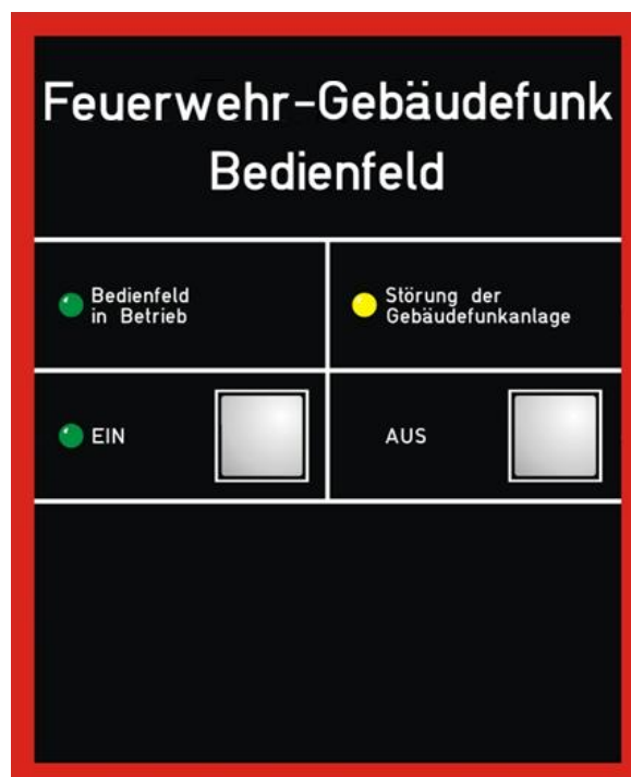
Abb. 1 - Feuerwehr-Gebäudefunk Bedienfeld (FGB)
