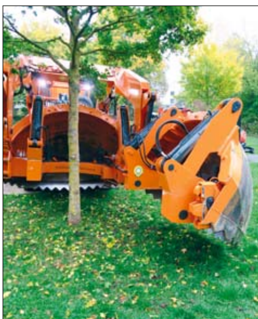
Das Spezialfahrzeug umgreift den Baum zunächst und gräbt ihn dann mit Hilfe der halbschalenförmigen Baggerschaufeln mitsamt dem Wurzelballen aus – und setzt ihn später wieder ein.
