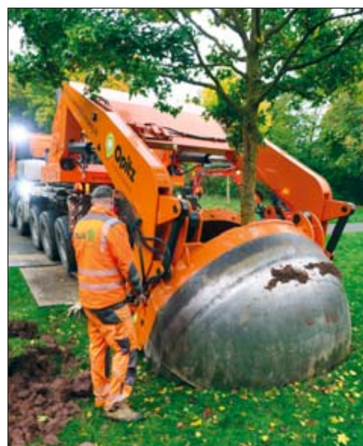
Das Spezialfahrzeug umgreift den Baum zunächst und gräbt ihn dann mit Hilfe der halbschalenförmigen Baggerschaufeln mitsamt dem Wurzelballen aus – und setzt ihn später wieder ein.
