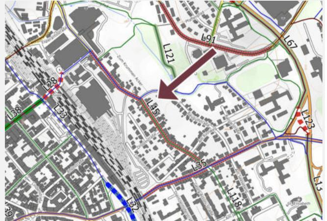
IST-Zustand: Es sind Radverkehrsanlagen markiert. Diese verfügen über keinen Sicherheitstrennstreifen und sind abschnittsweise zu schmal.
