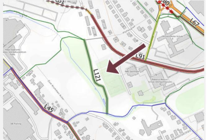
IST-Zustand: Der bestehende Weg ist zu schmal für Fuß- und Radverkehr. Es besteht eine Kante zwischen gepflasterten und wassergebundenem Wegeteil in Längsrichtung.
