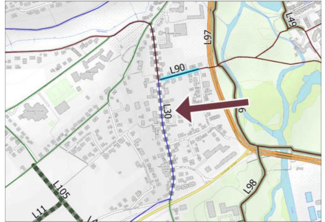
IST-Zustand: Es gibt keine Radverkehrsanlagen. Der Radverkehr wird auf der Fahrbahn geführt.
