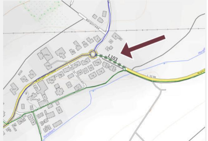
IST-Zustand: Der straßenbegleitende Radweg endet am Horasbach. Der folgende Abschnitt verfügt über keine Radverkehrsinfrastruktur. Radfahrende nutzen den Gehweg. Eine Überführung auf die Fahrbahn fehlt.
