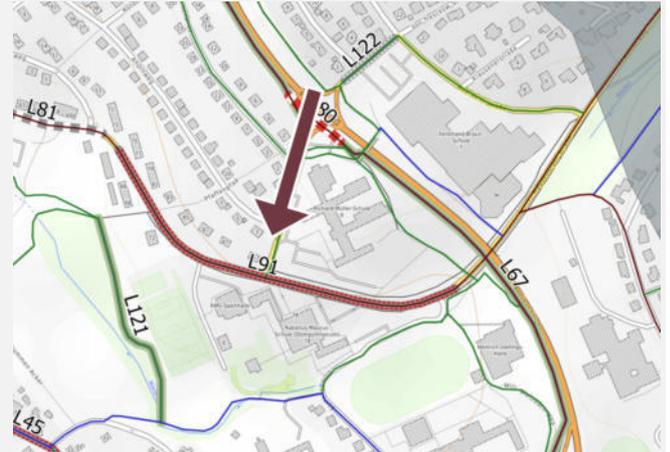
IST-Zustand: Es sind teilweise Radverkehrsanlagen markiert, teilweise bestehen nicht benutzungspflichtige getrennte Geh- und Radwege. Diese verfügen über keinen Sicherheitstrennstreifen und sind abschnittsweise zu schmal.
