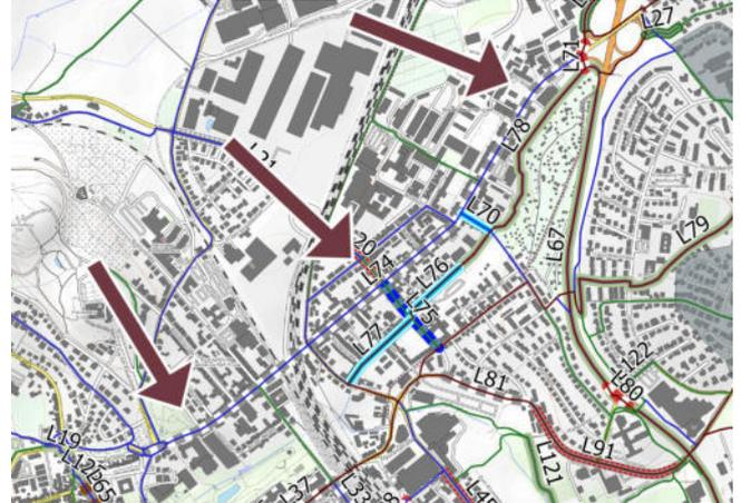
IST-Zustand: Es sind abschnittsweise Radverkehrsanlagen markiert. Diese verfügen über keinen Sicherheitstrennstreifen und sind teilweise zu schmal. Die Aufstellstreifen sind in der Regel nicht vorgezogen.
