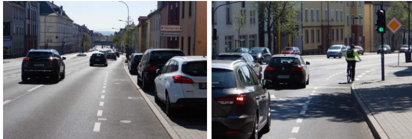
Abbildung 2: Schutzstreifen ohne Sicherheitstrennstreifen, die in der Knotenpunktzufahrt enden; Schutzstreifen ohne vorgezogenen Radaufstellstreifen
